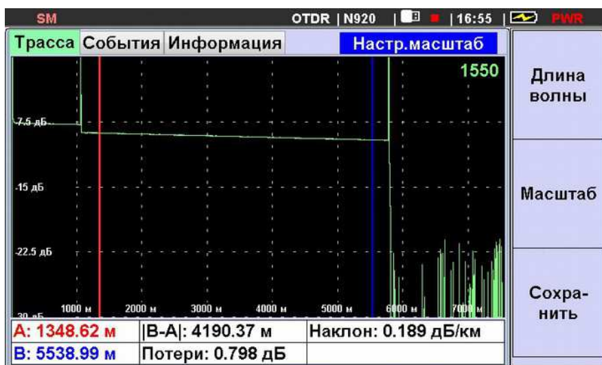
Рис. 5.14. Настройка масштаба отображения рефлектограммы.
