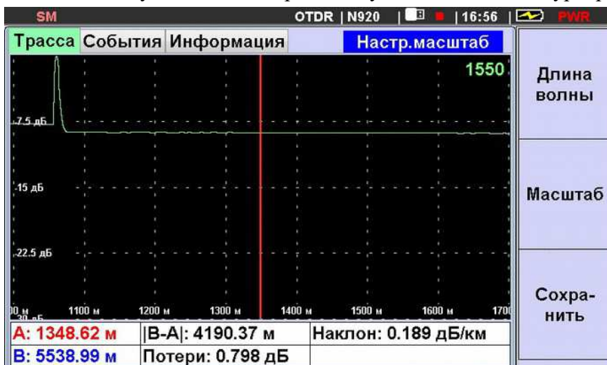
Рис. 5.15. Отображение участка рефлектограммы в режиме увеличения
