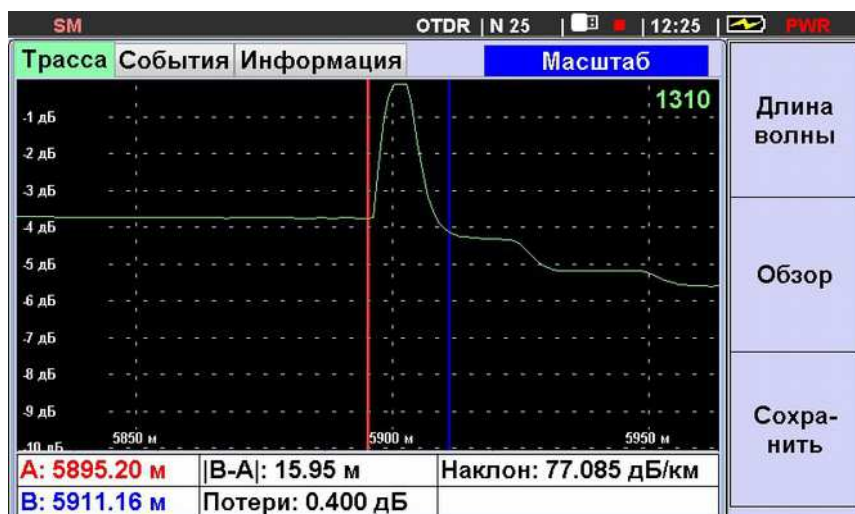
Рис. 5.20. Изображение выбранного события в масштабе
